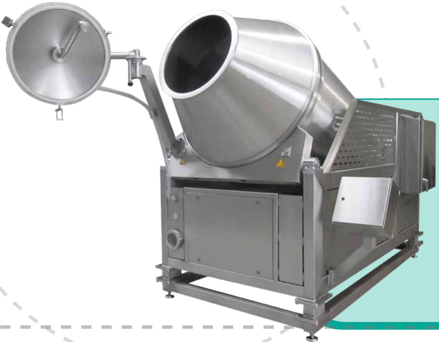
Durch eine Neigungsverstellung von 50° kann ein Füllvolumen von 60% garantiert werden. Zudem wird ein schnelles Entleeren durch Kippen des Behälters ermöglicht.
