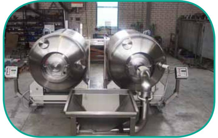
Vakuumbeschickung / vacuum loader
