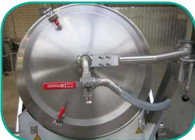
Der Vakuumtumbler Typ R ist am Deckel mit einem zusätzlichen Ventil ausgestattet, das dem Kunden erlaubt während des Tumbelvorgangs Lake nachzusaugen.
