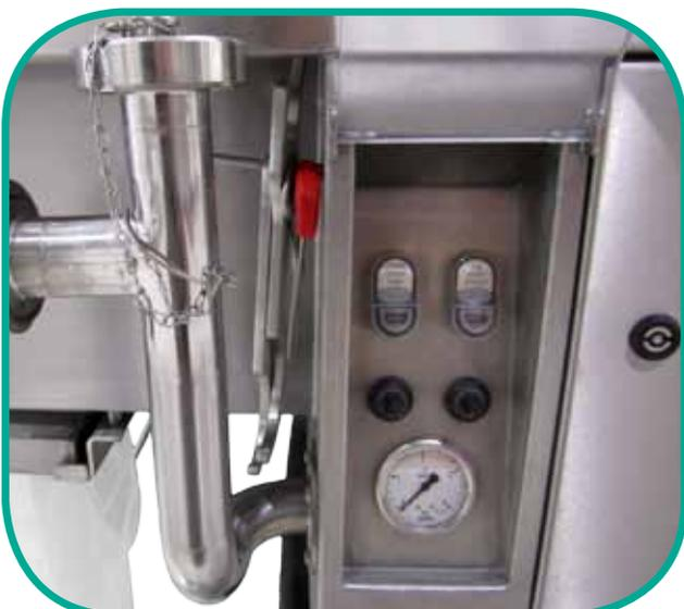
Die Injektorsteuerung zeichnet sich durch seine Bedienfreundlichkeit aus. Hubgeschwindigkeit und Vorschub sind durch den robusten Antrieb mit Frequenzumrichter mechanisch gekoppelt und absolut synchron.
