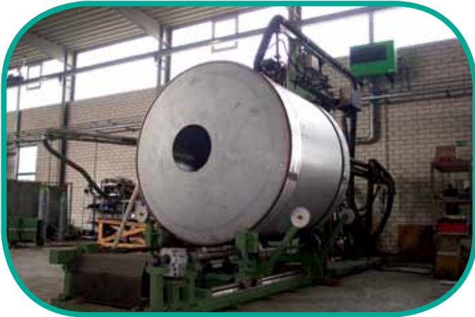
Ein robuster 4-Radantrieb spezieller Schwerlasträder und ein frequenzumrichter gesteuertes Getriebe ermöglicht einen Drehzahlbereich von 1 - 10 U/min. Die Doppeltürigkeit des Behälters verhilft zu einem schnellen Be- und Entladen sowie Reinigen.
