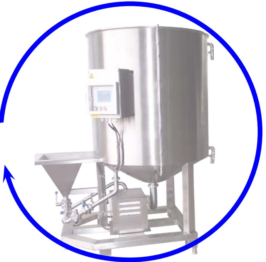
Über einen direkt aufgebrachtten Doppelmantel gelangt die Kälte oder Wärme mit besonders geringem Energieverlust an das Produkt.
