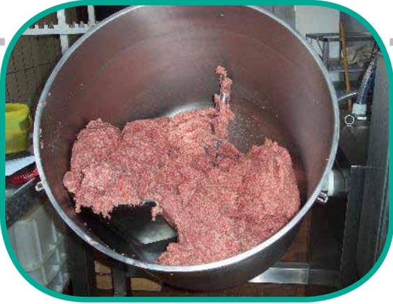
Je nach Produkt kommen unterschiedliche Mischwerkzeuge zum Einsatz. Der Polterarm ist mit einem speziellen Abstreifgummi ausgestattet, wodurch stets eine saubere Behälterwand gewährleistet wird.
