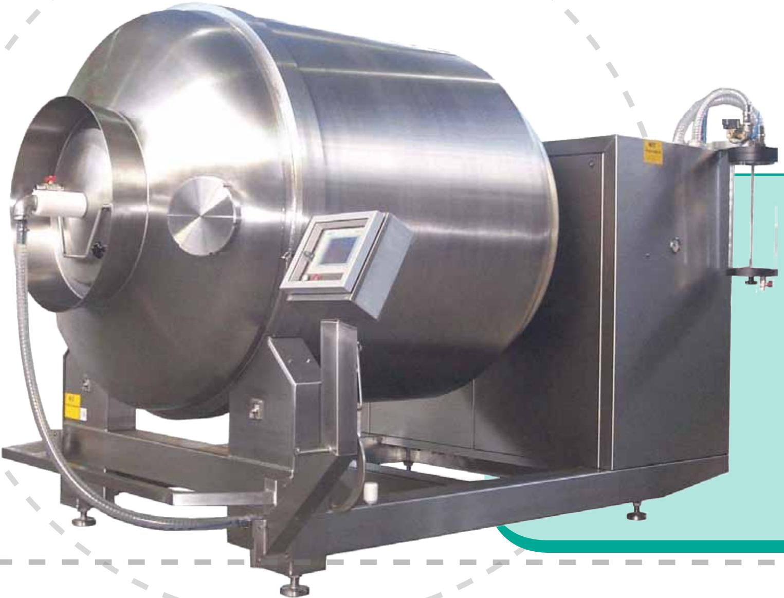
Die besonders stabile und bedienerfreundliche Konstruktion mit schonender bis sehr intensiver Massage sichert konstant höchste Qualität der Produkte. Der flexibel einsetzbare Hochleistungstumbler wird optional mit Kühl- und/oder Auftauvorrichtung gefertigt.
