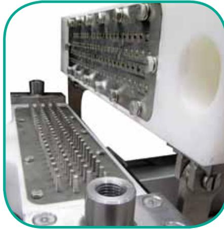
Der Druck der pneumatisch einzeln gefederten Nadeln kann stufenlos eingestellt werden. Alle Nadeln können zur Reinigung leicht und ohne Werkzeug entnommen werden. Je nach Produkt können 4, 3 oder 2,4 mm Nadeln verwendet werden.
